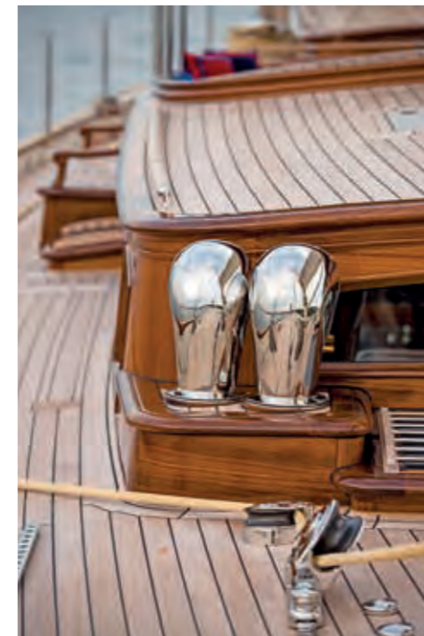
links: De geleiding van de kotterfokschoot voor het dekhuis. De schoot wordt helemaal achterop bediend
